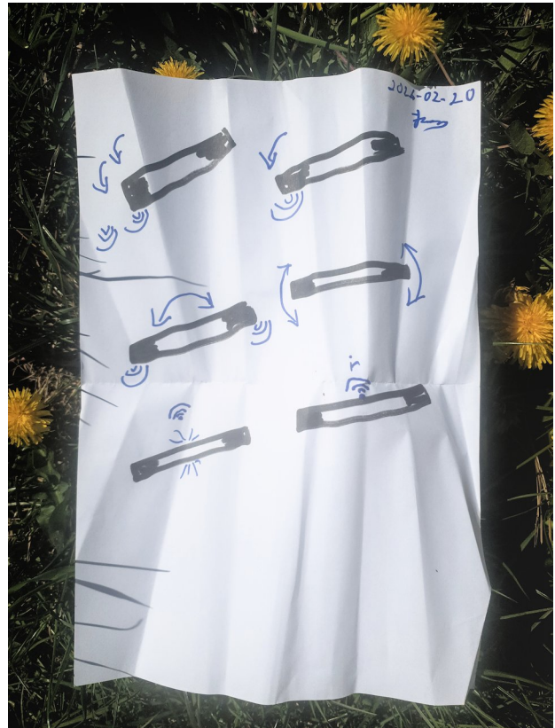
Figur 4: Tællestavsskitse, med ideer til interaktion: Tælling ved at tappe, skifte forbrugstype ved at tappe dobbelt, tappe i begge ender eller tippe staven til siderne, og aflæsning af optalte data via wifi eller infrarød sender.
